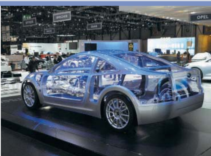
Krátke previsy, motor vpredu a pohon zadnej nápravy sľubujú v spojení s motorom boxer unikátne jazdné vlastnosti.
