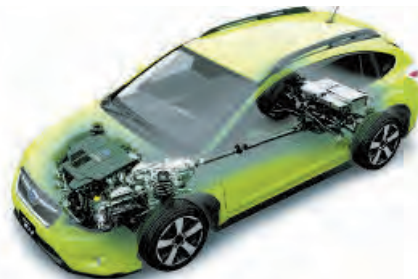
Batéria, invertor a konvertor DC-DC sú uložené pod dnom kufru.
