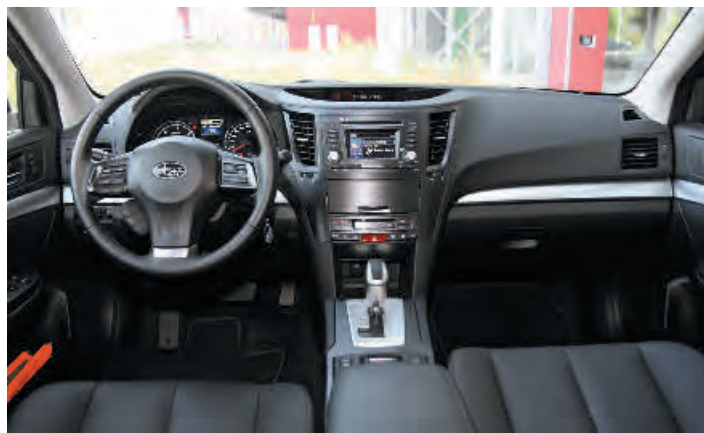
Obraz sériovej parkovacej kamery je integrovaný do 4,3-palcového displeja audiosystému.
