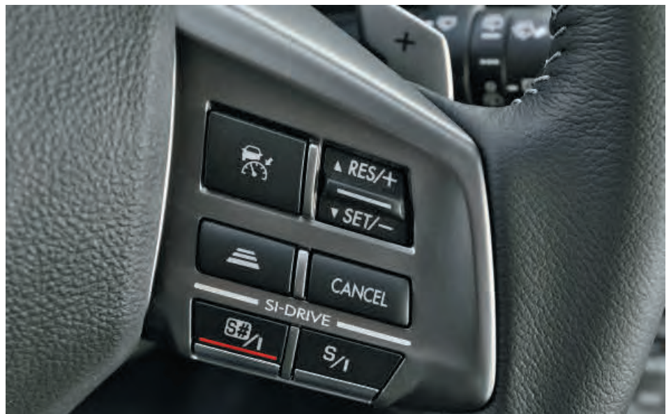
Adaptívny tempomat sa aktivuje na volante, kde sa nastavuje aj vzdialenosť od vpredu idúceho vozidla.
