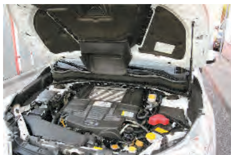
Charakteristický otvor na kapote je preč, vzduch ide k medzichladiču turba skrytými kanálmi. Všetko pre bezpečnosť chodcov.
