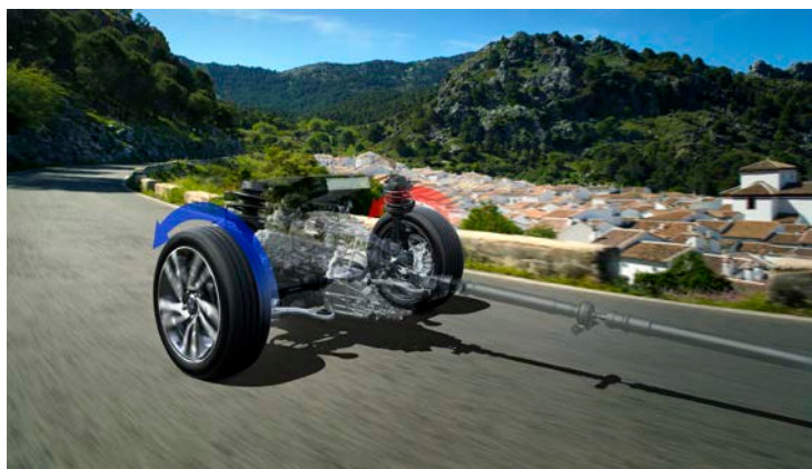
Systém Active Torque Vectoring pomáha rýchlejšiemu a bezpečnejšiemu prejazdu zákrut aktívnou distribúciou krútiaceho momentu medzi prednými kolesami.
